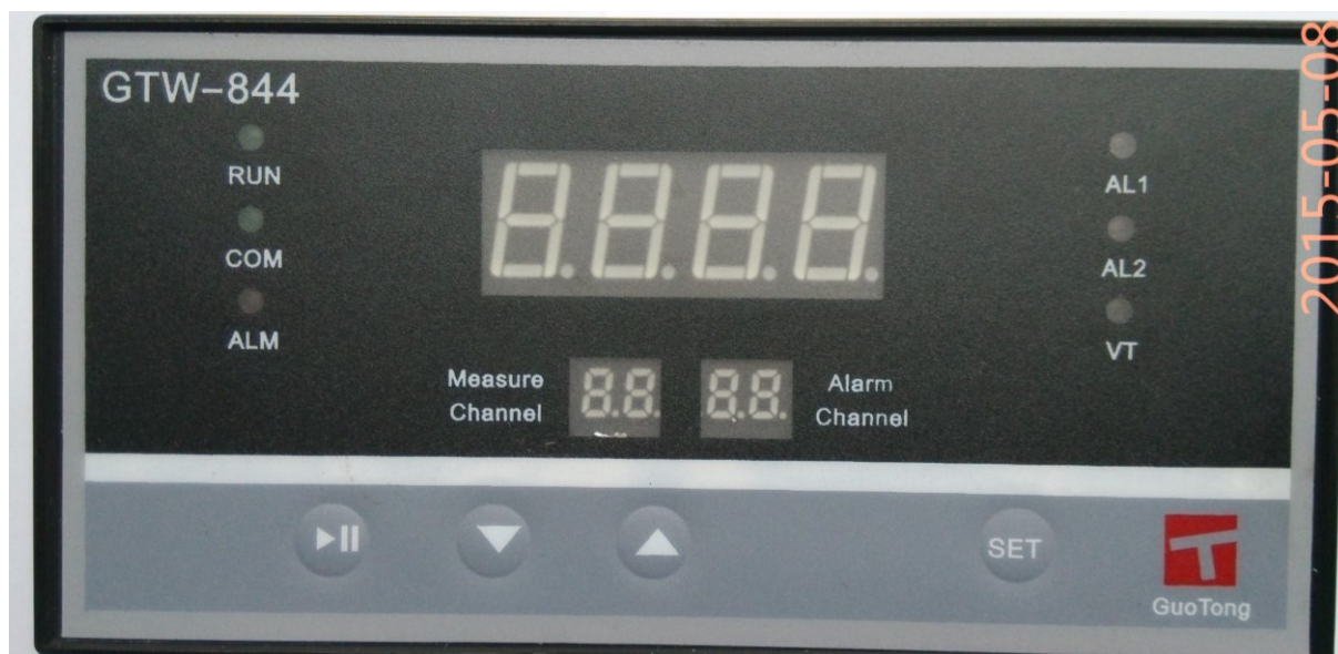
图一：GTW-844 温度巡检仪正视
