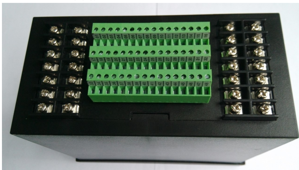
图二：GTW-844 温度巡检仪背视图
